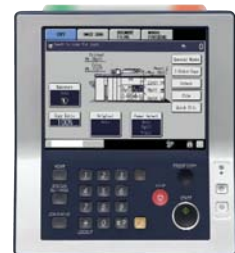
Panel táctil en color LCD con luces del estado de los trabajos de gran luminosidad
